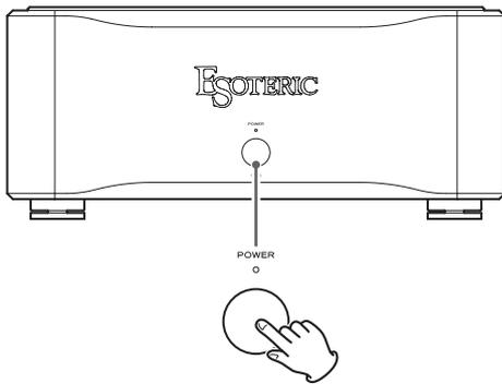
Nach dem Einschalten des Geräts blinkt die Power-Anzeige und es wird einige Sekunden lang kein Audiosignal ausgegeben. Warten Sie bis die Power-Anzeige zu blinken aufhört und durchgehend leuchtet, bevor Sie die Lautstärke anpassen und sonstige Einstellungen vornehmen.
