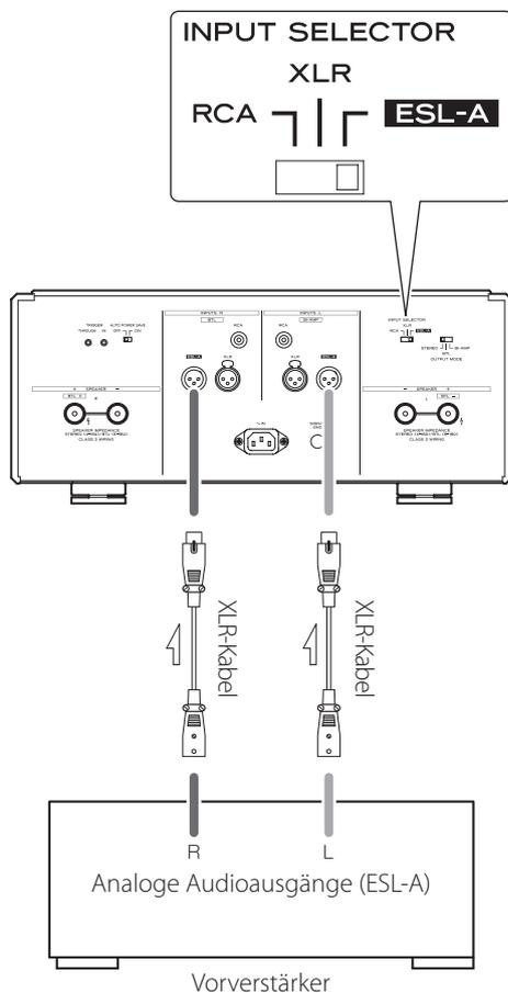
Verbinden Sie den analogen Audioausgang (ESL-A) eines Vorverstärkers mit Hilfe eines XLR-Kabels mit der Eingangsbuchse ES-LINK Analog (ESL-A) an diesem Gerät.
