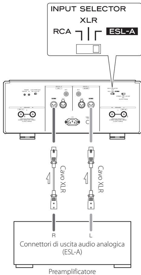
Utilizzare un cavo XLR per collegare il connettore di uscita audio analogica (ESL-A) di un preamplificatore al connettore di ingresso analogico ES-LINK Analog (ESL-A) di questa unità.
