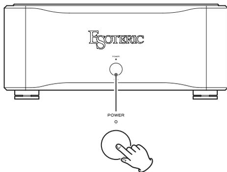
Dopo l'accensione dell'unità, l'indicatore di alimentazione lampeggia e nessun suono viene emesso per alcuni secondi. Attendere che la spia di alimentazione smetta di lampeggiare e rimanga accesa prima di regolare il volume ed effettuare altre operazioni.
